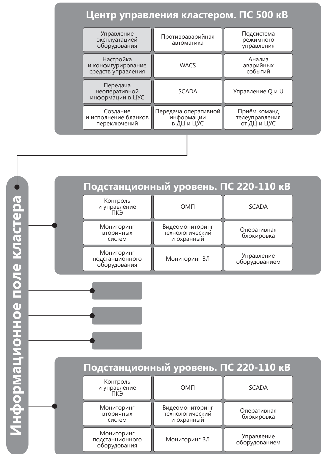
рис. 1 Функциональная структура АСУ ТП ЭК
